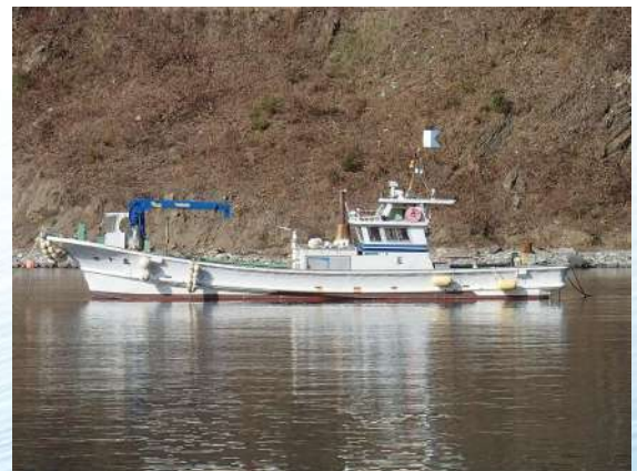
■名称：雄幸丸 作業船 ■メーカー名：大和造船所 ■L=11.65m B=2.8m H=0.8m ■エンジン：360ps
