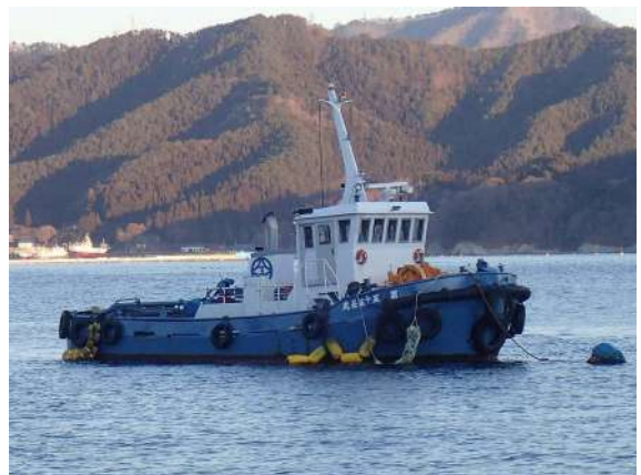
■名称：第55長丸 曳船 ■メーカー名：赤松造船 ■L=11.94m B=5.22m H=2.13m ■エンジン：750ps
