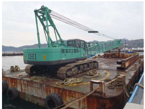
■名称：第18長丸 クレーン付台船 ■メーカー名：IHI建機 ■型式：70 t吊 ■台数：1台
