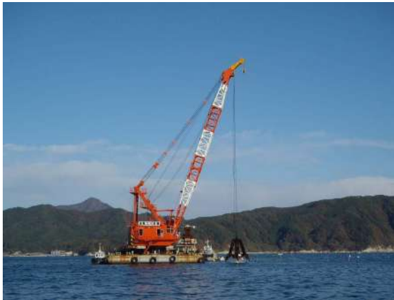
■名称：第1号長丸 非航式起重機船 ■メーカー名：IHI建機 ■型式：全旋回 250 t吊 ■台数：1隻
