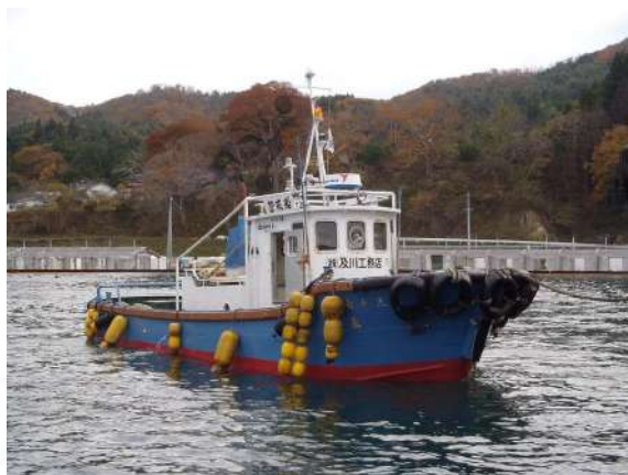
■名称：第37長丸 作業船 ■メーカー名：東洋造船鉄工所 ■L=9.75m B=2.8m H=1.05m ■エンジン：280ps×1基
